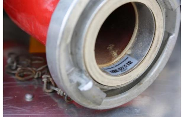
Das Etikett sollte die Größe „klein“ (30x15 mm) haben und **in** der mittleren Kupplung (Sonderrohr) verklebt werden. Wasser und auch Schaummittel können das Etikett nicht beschädigen.
