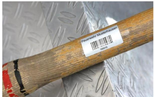
Das Etikett sollte die Größe „mittel“ (50x25 mm) haben und an einer wenig beanspruchten Stelle verklebt werden. Da Holzteile i.d.R. lackiert sind und der Lack sich mit der Zeit löst, empfehlen wir zusätzlich **über** das Etikett (um den Stiel) ein transparentes Klebeband anzubringen oder die Etiketten mit der zusätzlichen Schutz- Laminierung (optional erhältlich) zu bestellen.
