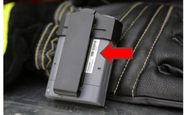
Das Etikett sollte die Größe „Mikro“ (30x6 mm) haben und entweder intern **im** Akkufach (da dieses bei einer Reparatur oder Prüfung i.d.R. sowieso geöffnet wird) oder alternativ auf der Rückseite (nur wenn dort der Gürtelclip eine Vertiefung bietet) verklebt werden.
