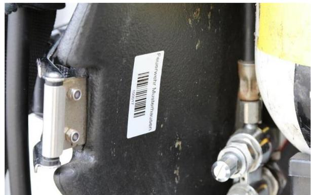
Das Etikett sollte die Größe „mittel“ (50x25 mm) haben und auf der **Rückseite** des Gerätes (Tragevorrichtung) verklebt werden.
